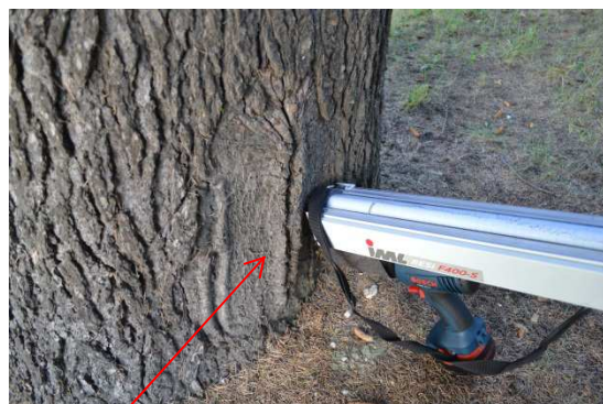
Blessure au niveau du collet utilisation du résistographe
